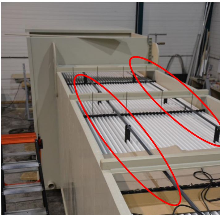
Twee lijnen sproeinozzles à 6 sproeiers per lijn
